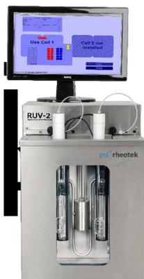
**Установки для измерения кинематической вязкости автоматические RUV-2** предназначены для автоматического измерения кинематической вязкости прозрачных и непрозрачных жидкостей в диапазоне вязкостей 0,6 ... 10 000 сСт и температур +15 ... +100 °С.
